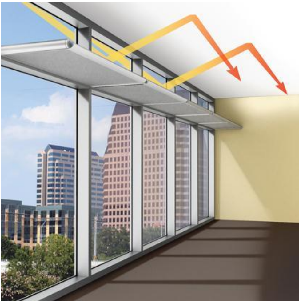
شکل ۱۰ نمونه‌ای طرح‌واره از اجرای طاقچه‌های نوری
